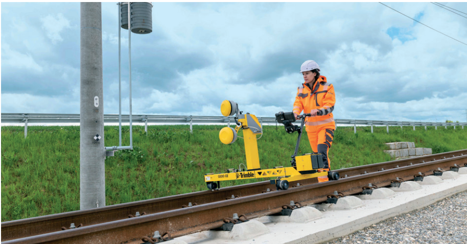
Abb. 1: Erfassung der Gleisumgebung mit dem Trimble Gedo IMS-Scan zur Erstellung einer 3D-Datengrundlage Quelle aller Abb: Trimble Railway GmbH
